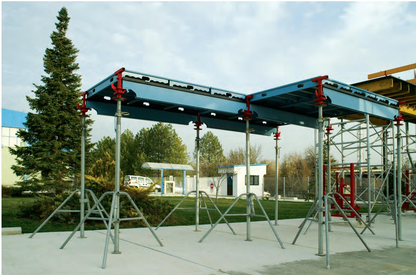
MESA DECK, düşer kafalı bir iskele/dikme sistemi üzerinde kullanılan, hafif aluminyum panellerden oluşan döşeme kalıp sistemidir. Bu elle taşınabilir sistem, uygun döşeme kalınlığı ve beton dayanımında kalıbin erken sökülmeye imkan sağlar. Düşer kafalar döşeme panellerinin ve ana kırışlerin kalıptan düşürülmesini sağlar. Bu sayede taşıyıcı sistem sökülmeden panellerin sökülecek diğer etapta kullanılması sağlanır.
